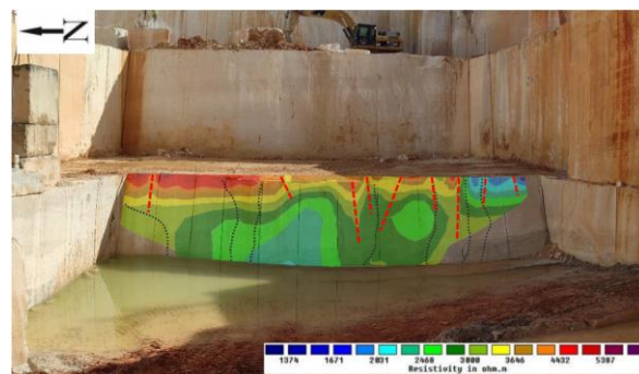
Fig. 3. Secção de resistividade elétrica, projetada na frente de desmonte da TRE 4 e marcação (tracejado a vermelho), de possíveis descontinuidades estruturais.
