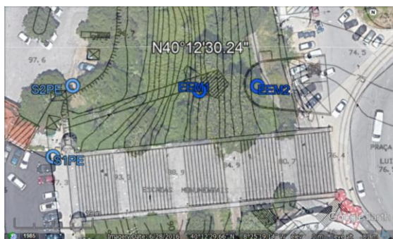
Fig. 1. Localização das duas sondagens realizadas em 2002 por solicitação da Universidade de Coimbra (S1PE e S2PE), e das duas sondagens realizadas no presente estudo (EEM1 e EEM2).
