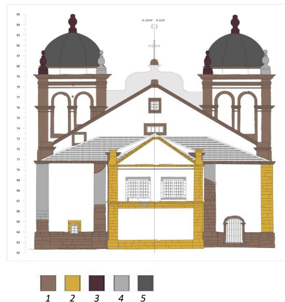
Fig. 1. Mapeamento dos diferentes tipos de pedra observáveis na fachada sul da Igreja de S. João Baptista (1 - traquito; 2 - tufo; 3 - basalto; 4 - argamassa de reparação; 5 - argamassa de revestimento) (Cunha, 2018).
