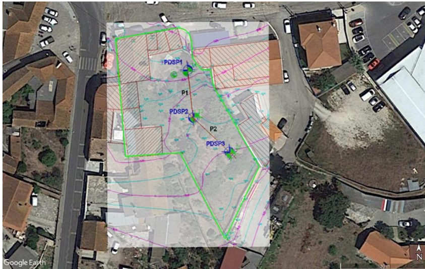
Fig. 1. Localização, em planta, dos Penetrómetros Dinâmicos Super Pesados (PDSP) e dos poços de prospeção (T).
