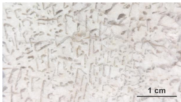
Fig. 1. Pormenor da textura gráfica numa amostra de mão do pegmatito da Venturinha.
