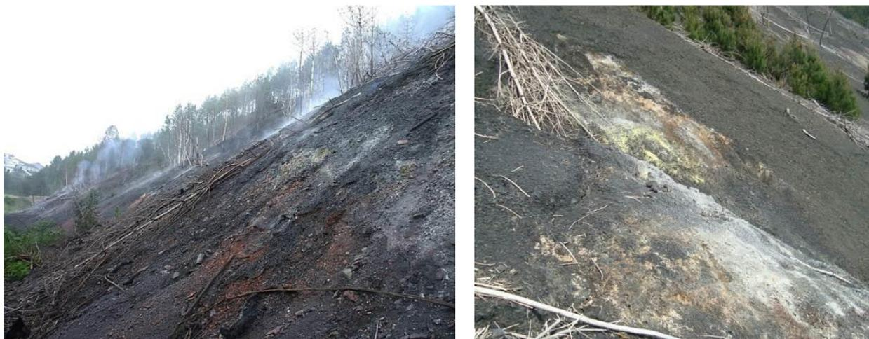
Fig. 1. Escombreira da mina de carvão de São Pedro da Cova em autocombustão (esquerda) e pormenor de alguns dos minerais de neoformação gerados, sal amoníaco e enxofre (direita)
